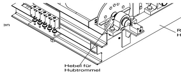
2. Vor einem Umschalten des Hebels muss das Schloss mit dem Schlüssel geöffnet werden. Dieses Schloss löst sich dann ca. 2 cm nach oben, der Umschaltmechanismus wird frei und kann betätigt werden.
